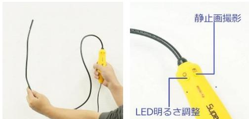
約 1m のくねくね曲がるアームの先端に小型のカメラが搭載されています。手元のリモコンで LED ライトの調整と静止画撮影の操作が可能です。
