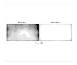
工場での厳密な色調整、ムラ補正回路搭載
